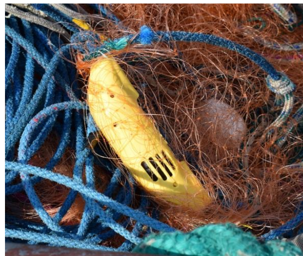
Rys.6 Akustyczne urządzenia odstraszające (Banana pinger firmy Fishtek Marine) zamontowane na sieciach skrzelowych
