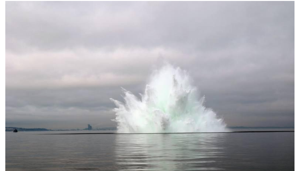
Rys.13 Detonacja broni konwencjonalnej bez użycia kurtyny powietrznej
