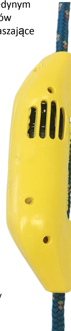
Rys.6 Akustyczne urządzenia odstraszające (Banana pinger firmy Fishtek Marine) zamontowane na sieciach skrzelowych
