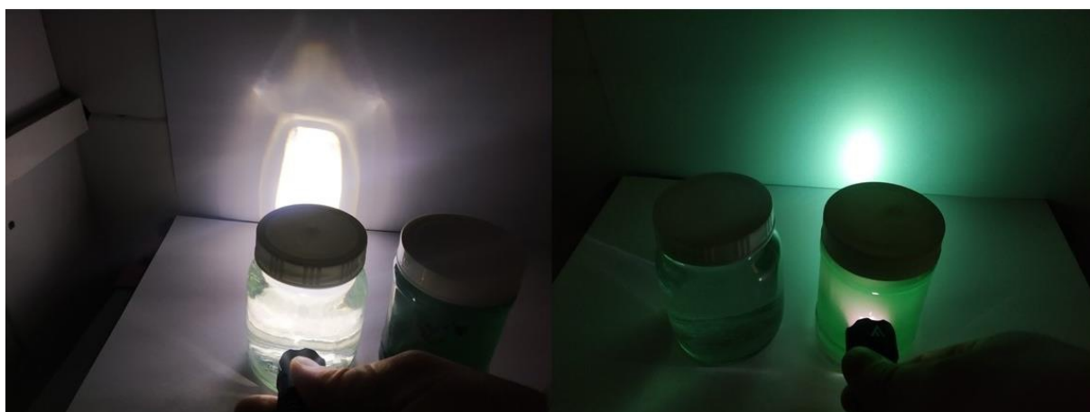
transmisja (przepuszczalność) światła przez słoik z wodą i słoik z roztworem spiruliny
