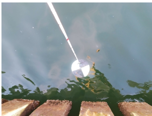
Wykorzystanie krążka Secchiego w pomiarze przejrzystości wody
